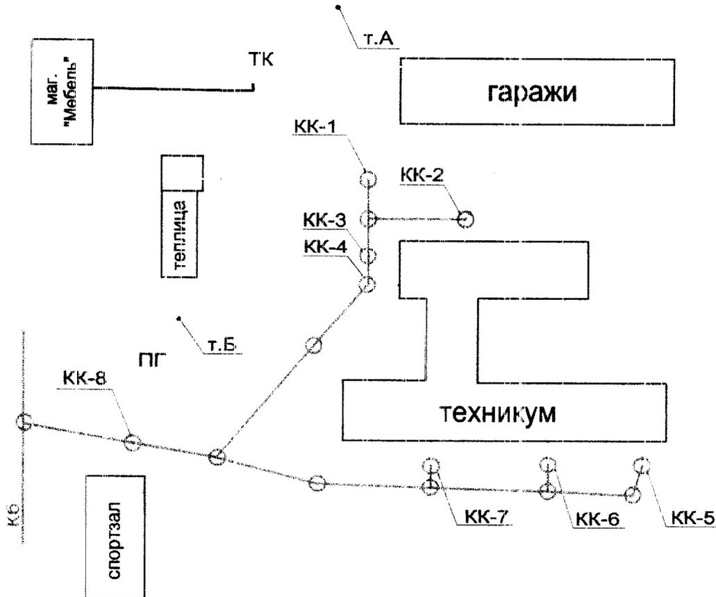
**ПО ВОДОСНАБЖЕНИЮ:** ГПОУ "УПТ" обслуживает внутренние и наружные водопроводы до наружной стены зданий и точек подключения к сети ООО "Водоканал-Сервис" (т.А, т.Б).
