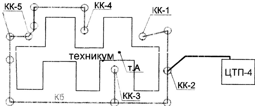
**ПО ВОДОСНАБЖЕНИЮ:** ГПОУ "УПТ" обслуживает внутренний водопровод до точки подключения к сети ООО "Водоканал-Сервис" (т.А).
